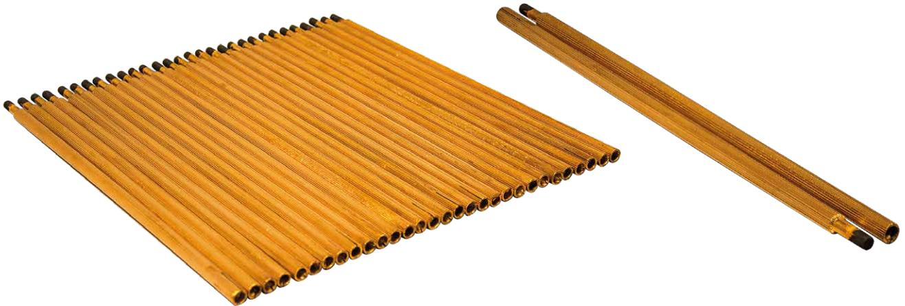
Pouvant être utilisées à des valeurs de courant élevées, les électrodes en carbone permettent une découpe facile et rapide des métaux à l'échelle épaisse et en même temps donnent la possibilité d'ouvrir une rainure jusqu'à 25 mm en un seul passage en fonction du diamètre utilisé. C'est la méthode la plus appropriée, avec l'avantage d'observer les fissures pendant le rainurage et pour réparer les coins cassés et les éliminer les empilements inutiles.
